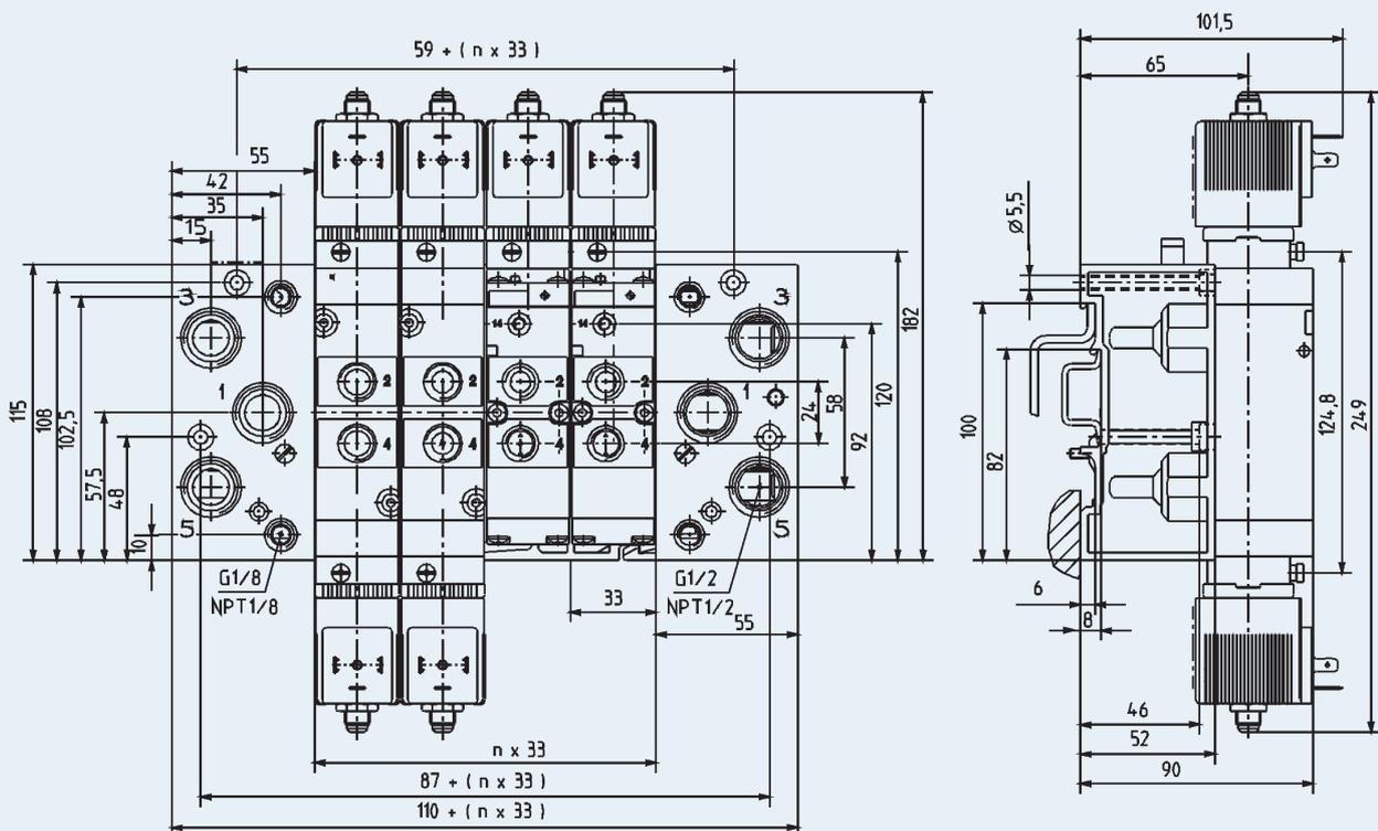
Монтаж клапанов на модуль MP07 при помощи входящих в комплект поставки винтов M4.
