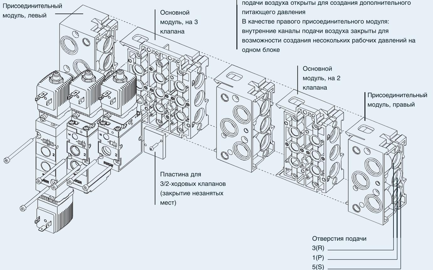
В качестве промежуточного модуля: внутренние каналы подачи воздуха открыты для создания дополнительного питающего давления
